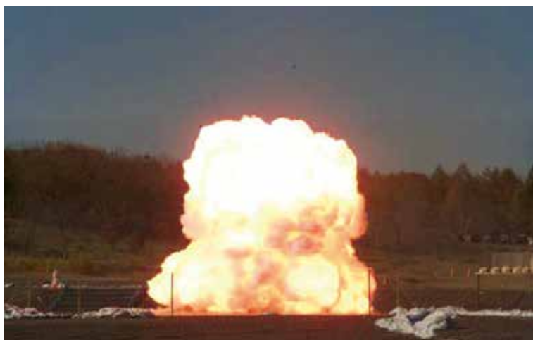
黒色火薬40kg 起爆後80ms 【平成28年度 火薬類爆発影響低減化技術基準検討事業】
