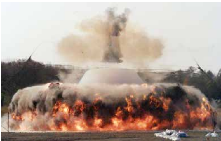
ANFO160kg 起爆後5ms 【平成28年度 火薬類爆発影響低減化技術基準検討事業】
