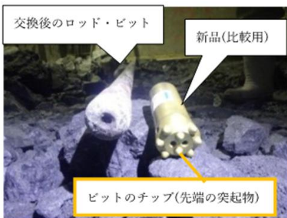
摩耗したビット状況 (正面)
