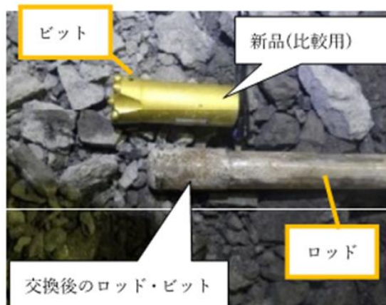
摩耗したビット状況 (側面)
