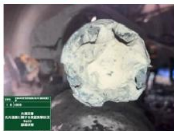
写真4. 疑似ジャミング後のビット写真
