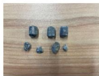
写真5. 孔内高温時孔から出てきたチップ写真
