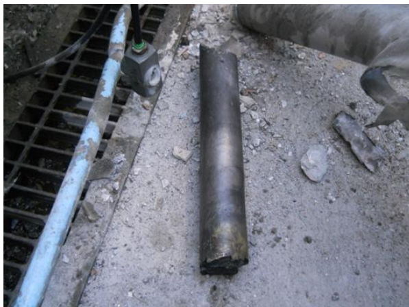
破断した押棒
