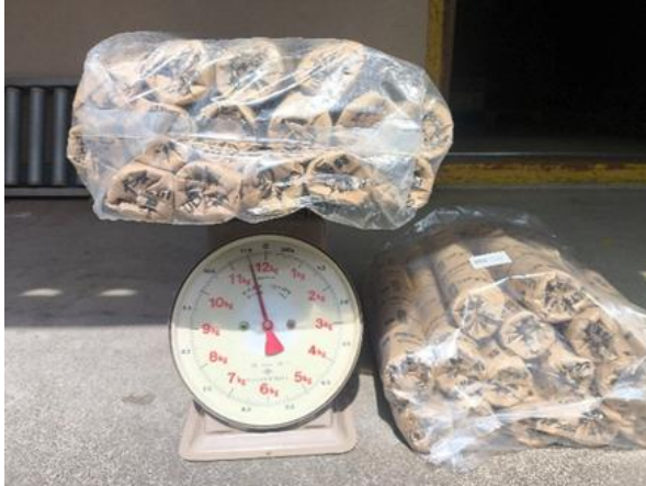
回収した原形のままの含水爆薬 15 本の例
